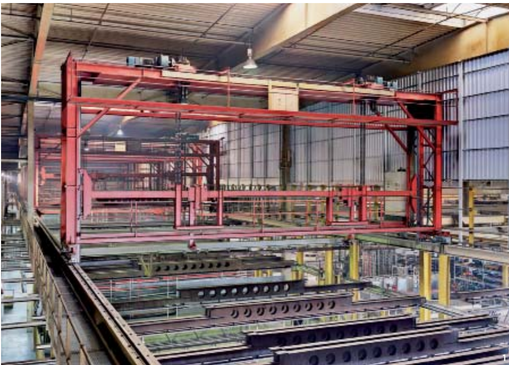
1 BOT betreibt eine der größten KTL-Beschichtungsanlagen in Europa: Hier können bis zu 12200 x 700 x 2300 mm große und bis zu zwei Tonnen schwere Bauteile vollautomatisch beschichtet werden. 2 Das BOT-Beschichtungssystem wird schon seit längerem erfolgreich bei verschiedenen Anwendungen eingesetzt, unter anderem bei Landmaschinen (im Bild Ladebordwände). 3 Die ›OR-6000‹-Beschichtung schützt die Laschen und Anschlüsse des Metropol Parasol, eine der größten Holzkonstruktionen der Welt, vor der mäßig aggressiven Meeresluft in Sevilla.
