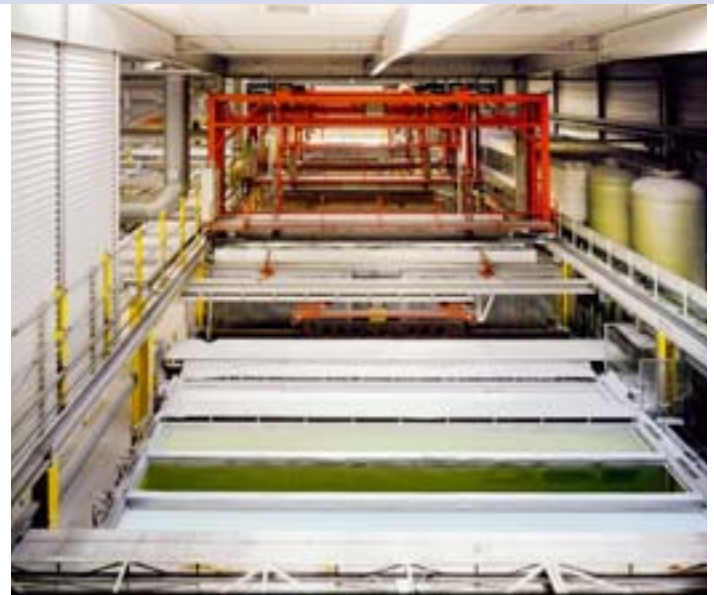
Auch große Dimensionen sind kein Problem: Die Tauchbecken für Zink-Phosphatierung und KTL-Beschichtung fassen bis zu 12 200 x 700 x 2300 mm große und bis zu 2 t schwere Bauteile
