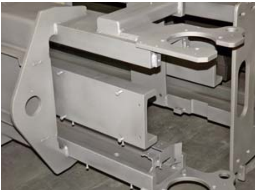
Die mit dem OR-6000-System beschichteten Bauteile übertreffen selbst die Anforderungen der höchsten Korrosivitätsklasse C5 der Norm DIN EN ISO 12944
