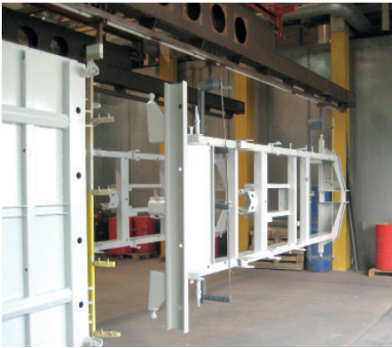
Eine Tauch-Zinkphosphatierung ermöglicht eine Verankerung der folgenden Beschichtungen
