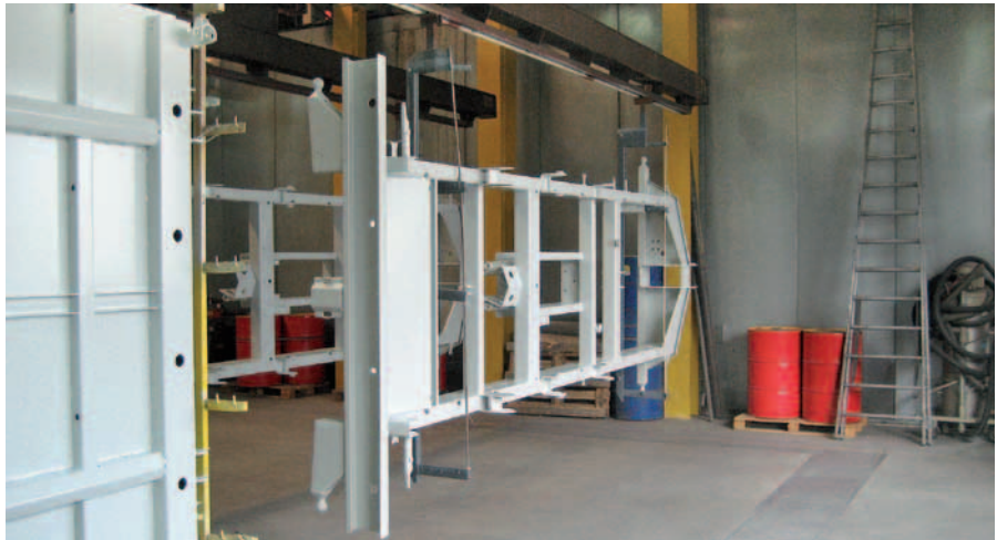
Selbst komplett montierte Anhängerrahmen lassen sich in der KTL-Beschichtungsanlage von BOT in einem Durchlauf beschichten.
