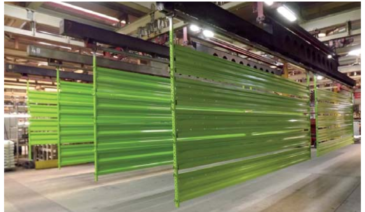
Die gesamte Beschichtung – vom Strahlen bis zur Pulverlackierung – läuft im BOT-Werk vollständig automatisch ab. Foto: BOT
