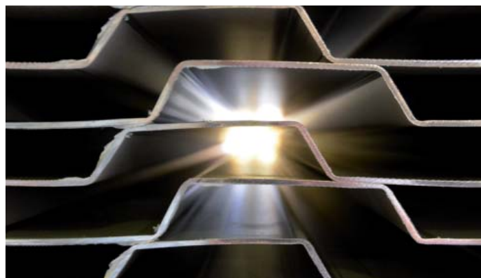
Bei dem Beschichtungsverfahren wird die dünnwandige Bordwand im gesamten Prozess nur mit Temperaturen von maximal 180 °Celsius belastet – Verformungen durch Hitzeeintrag werden so vermieden. Foto: bowa
