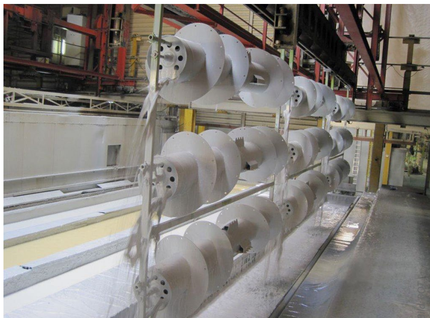
Das BOT-Beschichtungssystem wird schon seit Längerem erfolgreich eingesetzt, unter anderem bei Landmaschinen
