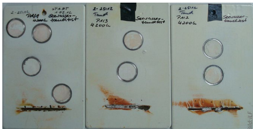
Die Proben mit der BOT-Beschichtung nach 4200 Stunden Seewassertauchttest
